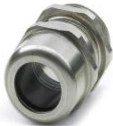
Кабельный ввод, материал резьбового соединения: Нержавеющая сталь 1.4305, наружный диаметр кабеля 15 мм ... 21 мм, экранировка: нет, резьба соединительной части: M32 x 1,5, цвет: серебристый, с уплотнительным кольцом
