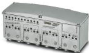
Устройство цифрового ввода/вывода для PROFINET; 100Base-TX, система быстрого запуска, SNMPv2, TFTP, LLDP, PDev, восемь входов (24 В DC), восемь настраиваемых входов или выходов (24 В DC, макс. 0,5 А), технология подключения VARIOSUB Push-Pull, прочный металлический корпус, класс защиты IP67
