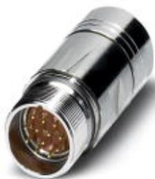
Переходные соединители, прямой, Винтовой зажим, M23, полюсов: 12, тип контактов: Штифт, Обжим, экранирован.: есть, диапазон диаметра кабеля: 5 мм ... 13,2 мм
