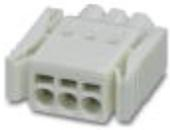
Разъемы для печатной платы, номинальный ток: 6 А, расчетное напряжение (III/2): 160 В, полюсов: 6, размер шага: 2,5 мм, тип подключения: Пружинные зажимы Push-in, цвет: белый, поверхность контакта: олово
