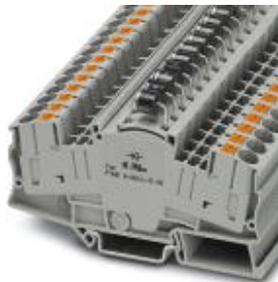
Клеммный блок, со встроенным диодом P1000M, тип подключения: Зажимы Push-in, сечение: 0,5 мм<sup>2</sup> - 10 мм<sup>2</sup>, AWG: 20 - 10, ширина: 8,2 мм, цвет: серый
