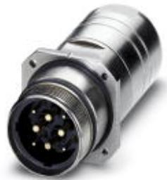
Проходная часть, задняя часть стенки, прямой, короткий, Винтовой зажим, M40, полюсов: 4+3+PE, тип контактов: Штифт, Обжим, Аксиальное уплотнительное кольцо, 4xM4, экранирован.: есть, диапазон диаметра кабеля: 17 мм ... 21 мм
