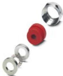
Резьбовой сальник Pg21 с частично нарезанной резьбой (защищен от ЭМВ), для металлических корпусов типоразмеров 2-4, в комплект входит резиновое уплотнение, пружина, конусная шайба и прижимная винтовая деталь, для корпусов типоразмера 1, диапазон зажима экрана кабеля 5,5-9,5 мм, кабель 9-13 мм
