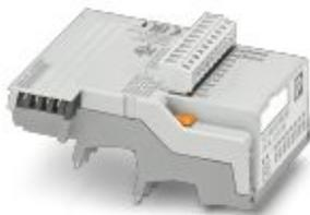
Логический модуль расширения PLC logic с 16 вводами-выводами для вставного подключения к 8 клеммам PLC-INTERFACE с целью расширения базового модуля (к одному базовому модулю можно подключить не более двух модулей расширения), винтовой зажим
