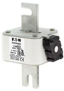
Предохранитель, высокая скорость, 900 A, AC 1000 V, DIN 3, 74 x 92 x 138 мм, aR, DIN, IEC, одинарный индикатор
