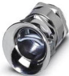
Металлический резьбовой крепежный элемент с приспособлением для защиты от зарегиба кабеля и снятия растягивающего усилия, длина резьбы: 7 мм, диапазон плотности кабеля: 10 - 19 мм, клеммный диапазон: 14 - 21 мм, SW 30, винтовое крепление: M25
