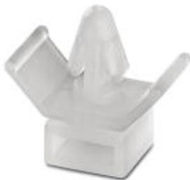
Основание для кабельной стяжки, для кабельных зажимов шириной до 8 мм, с залитой насеченной заклепкой, диаметр отверстия 6,5 мм, для материалов толщиной до 3 мм
