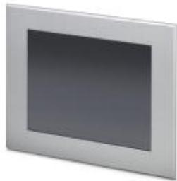
Сенсорная панель с TFT-дисплеем 30,7 см / 12,1"-дисплей (Промышл. высокопрочный сенсорный экран), 800 x 600 Пиксел (SVGA), 262144 цветов, Xscale® PXA320, 806 MHz, 2x USB Host 1.1, 1x Ethernet (10/100 Мбит/с), RJ45, Windows CE 6.0 и прикладное ПО: Visu+ / AX OPC Server. (шинная система: PROFIBUS DP)
