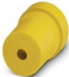
Резиновое уплотнение для резьбового крепежного элемента Pg13,5, для проводников диаметром 4,0 мм ... 6,5 мм
