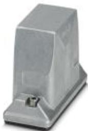
Сальниковый корпус В16, Винтовой зажим, материал: Из алюминия, методом литья под давлением, стойкий к морской воде, на заказ, высота: 93,7 мм, кабельный ввод: без, патрубок: Нет, Прибрежная зона/ЭМС, проводящее уплотнение (свойства ЭМС), без резьбового отверстия для завинчивания
