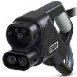
Зарядный кабель пост. тока с автомобильным зарядным штекером, без разъема с другого конца, CCS тип 2, Combined Charging System, МЭК 62196-3, 125 А / 1000 В (DC), тип конструкции Стандартный, кабель: 7 м, черный, прямой, ВНИМАНИЕ: могут потребоваться кабельные принадлежности., поверхность сопряжения: черный, область захвата: серый
