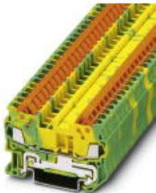
Клемма защитного провода, тип подключения: Быстрое подключение, количество точек подсоединения: 2, сечение: 0,25 мм<sup>2</sup> - 1,5 мм<sup>2</sup>, AWG: 24 - 16, ширина: 5,2 мм, цвет: желто-зел., тип монтажа: NS 35/7,5, NS 35/15
