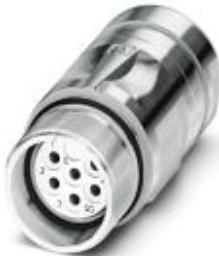
Переходной соединитель, прямой, экранирован.: есть, для стандартной блокировки и SPEEDCON, M23, Полосов: 6, тип контактов: Розетка, Подключение пайкой, диапазон диаметра кабеля: 4 мм ... 6 мм
