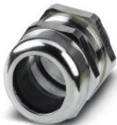
Кабельный ввод, материал резьбового соединения: латунь, никелированный, наружный диаметр кабеля 27 мм ... 38 мм, экранировка: нет, резьба соединительной части: M50 x 1,5, цвет: серебристый, с уплотнительным кольцом
