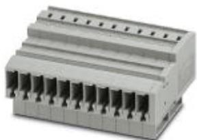
Соединитель COMBI, номинальное напряжение: 800 В, номинальный ток: 32 А, тип подключения: Пружинный зажим, количество точек подсоединения: 2, полюсов: 11, сечение: 0,08 мм<sup>2</sup> - 6 мм<sup>2</sup>, AWG: 28 - 10, ширина: 68,2 мм, высота: 31 мм, цвет: серый, тип монтажа: на монтажную пластину
