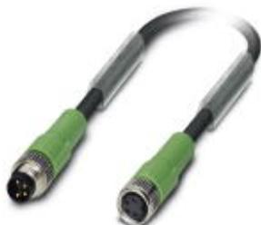
Кабель для датчика / исполнительного элемента, 4-полюсн., PUR без галогенов, темно-серый RAL 7021, Штекеры прямое M8, к Гнездо прямое M8, длина кабеля: 0,3 м
