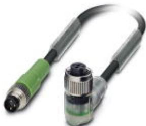
Кабель для датчика / исполнительного элемента, 3-полюсн., PUR без галогенов, темно-серый RAL 7021, Штекеры прямое M8, к Гнездо угловой M12, А-кодирование, с 2 светодиодных, длина кабеля: 0,3 м
