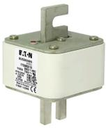
Предохранитель, высокая скорость, 1100 А, AC 690 V, DIN 3, 76 x 76 x 109 мм, aR, DIN, IEC, одинарный индикатор
