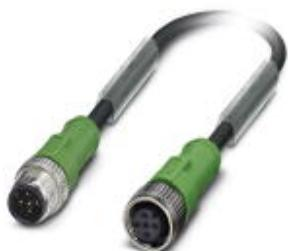
Кабель для датчика / исполнительного элемента, 5-полюсн., PUR без галогенов, темно-серый RAL 7021, Штекеры прямое M12, А-кодирование, к Гнездо прямое M12, А-кодирование, длина кабеля: 5 м
