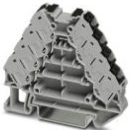
Распределитель потенциала, без нажимной кнопки, номинальное напряжение: 250 В, номинальный ток: 17,5 А, сечение: 0,14 мм<sup>2</sup> - 2,5 мм<sup>2</sup>, AWG: 14 - 26, тип подключения: Зажимы Push-in, полюсов: 2, количество подключений: 16, ширина: 8,3 мм, длина: 64 мм, цвет: серый, цвет элементов подключения: черный, монтаж: NS 35/7,5, NS 35/15
