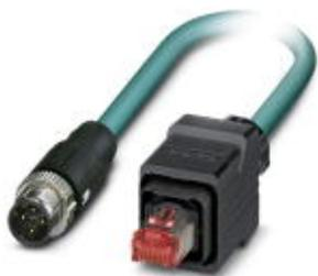
Сетевой кабель, Ethernet CAT5 (100 Мбит/с), 4-полюсн., PUR, цвет морской воды RAL 5021, экранирован., Штекеры прямое M12 SPEEDCON / IP67, механические ключи: D, к Штекеры прямое RJ45 Крепление на защелках / IP67, длина кабеля: 2 м
