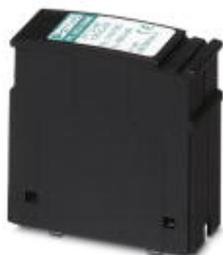
Штекерный модуль для защиты от перенапряжений для базового элемента, обеспечивает грубую и тонкую защиту от перенапряжений между двумя незаземленными сигнальными проводниками телекоммуникационных систем и между ними и токопроводящей частью, и от перенапряжений между токопроводящей частью и землей. Исполнение: 12 В DC
