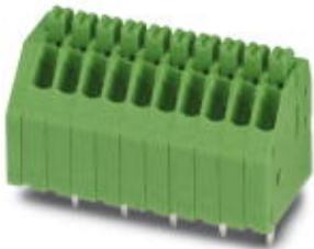
Клеммы для печатной платы, номинальный ток: 2 А, номинальное напряжение: 250 В, размер шага: 2,5 мм, полюсов: 21, тип подключения: Пружинные зажимы Push-in, монтаж: Пайка волной припоя, направление подключения, проводник/печатная плата: 45 °, цвет: зеленый. Смешанные выводы под пайку, двухрядн.
