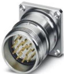
Приборный соединитель, задняя часть стенки, прямой, экранирован.: есть, Винтовой зажим, M23, Полюсов: 12, тип контактов: Штифт, Обжим, Плоское уплотнение, 4xM3, Толщина стенок, мин.: 3 мм, Толщина стенок, макс.: 10,5 мм
