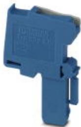
Штекер, номинальное напряжение: 500 В, номинальный ток: 24 А, тип подключения: Пружинный зажим, количество точек подсоединения: 1, полюсов: 1, сечение: 0,08 мм<sup>2</sup> - 4 мм<sup>2</sup>, AWG: 28 - 12, ширина: 5,2 мм, высота: 34 мм, цвет: синий
