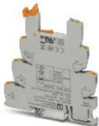
6,2 мм основная клемма PLC с зажимом push-in, без реле или полупроводниковых реле, для монтажной рейки NS 35/7,5, 1 переключающий контакт, входное напряжение 125 В DC
