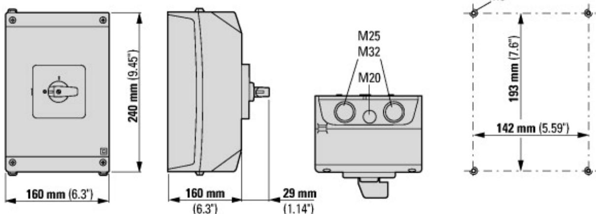
Кулачковые выключатели Т5В и Т5 имеют одинаковую конструкцию, они различаются только контактами
