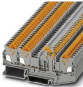
Клеммы с ножевыми размыкателями, номинальное напряжение: 400 В, номинальный ток: 17,5 А, тип подключения: Быстрое подключение, сечение: 0,25 мм<sup>2</sup> - 1,5 мм<sup>2</sup>, AWG: 24 - 16, длина: 94 мм, ширина: 5,2 мм, цвет: серый, монтаж: NS 35/7,5, NS 35/7,5, номинальное напряжение: 400 В
