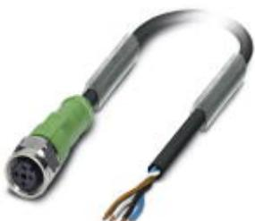
Кабель для датчика / исполнительного элемента, 4-полюсн., PUR без галогенов, темно-серый RAL 7021, свободный конец, к Гнездо прямое M12, А-кодирование, длина кабеля: 20 м
