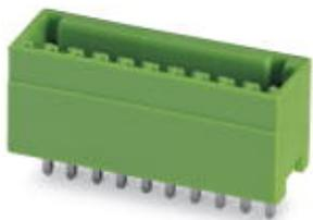
Корпусная часть для печатных плат, номинальный ток: 4 А, расчетное напряжение (III/2): 160 В, полюсов: 9, размер шага: 2,5 мм, цвет: зеленый, поверхность контакта: олово, монтаж: Пайка волной припоя
