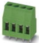
Клеммы для печатной платы, номинальный ток: 24 А, номинальное напряжение: 400 В, размер шага: 5 мм, полюсов: 4, тип подключения: Винтовой зажим с натяжной гильзой, монтаж: Пайка волной припоя, направление подключения, проводник/печатная плата: 0 °, цвет: зеленый. Возможна установка в ряд модулей с различным количеством полюсов (контактов)!
