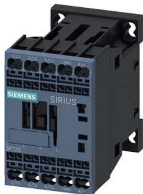
Силовой контактор, AC-3 7 A, 3 кВт/400 В 1 НО, 48 В DC 3-полюсн., типоразмер S00, пружинная клемма
