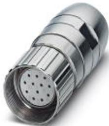
Кабельный соединитель, прямой, экранирован.: есть, Винтовой зажим, M23, Полосов: 16, тип контактов: Розетка, Подключение пайкой, диапазон диаметра кабеля: 7 мм ... 8,5 мм
