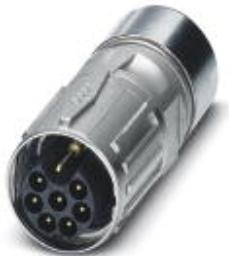
Кабельный соединитель, прямой, Крепление SPEEDCON, M17, полюсов: 5+3+PE, тип контактов: Штифт, Обжим, экранирован.: есть, диапазон диаметра кабеля: 9 мм ... 11,2 мм
