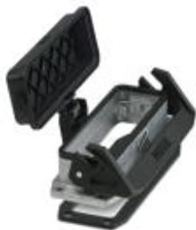
Блочный корпус HEAVYCON B24, с продольной защелкой, пластиковой защитной крышкой и плоским уплотнением, стойкий к морской воде алюминий, проводящее профильное уплотнение.
