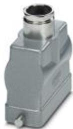
Сальниковый корпус HEAVYCON B16, для крепления одной защелкой, высота 76 мм, с резьбовым соединением 1x Pg21, прямой ввод кабеля
