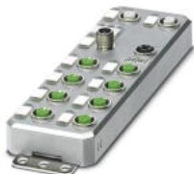
Axioline E, Устройство цифрового ввода, EtherCAT®, Технология быстрого подсоединения M12, Цифровые входы: 16, 24 В DC, способ подключения: 4-проводная схема, Металлический корпус, степень защиты: IP65/IP67
