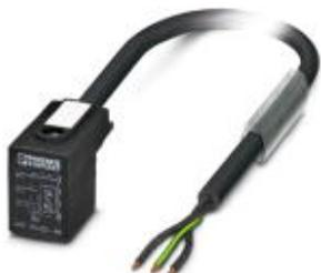
Кабель для датчика / исполнительного элемента, 3-полюсн., PUR без галогенов, темно-серый RAL 7021, свободный конец, к Штекер типа В для электромагнитного клапана (10 мм), с 1 светодиод, подключение с помощью Диод Зенера, длина кабеля: 0,15 м, конец без разъема = 350 мм
