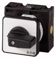
Переключатель включения/выключения, 3-полюсн. + 2 Замыкающие контакты + 1 Размыкающие контакты, 32 А, 90 °, Монтаж
