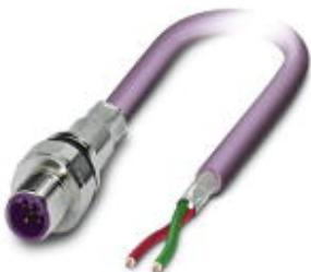
Встраиваемый разъем (вилка) шинной системы, PROFIBUS, 2-полюсный, M12, экранированный, с механическим ключом В-типа, монтаж с передней части стенки / резьбовое крепление с M16, позиционируемый, с кабелем шины длиной 0,22 м, 2 x 0,32 мм<sup>2</sup>
