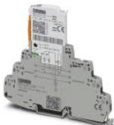
Устройство защиты от перенапряжений (защитный штекер и базовый элемент), со встроенным индикатором состояния для двух сигнальных проводников с общим опорным потенциалом, например Digital IN/OUT. Непрямое заземление через газовый разрядник.
