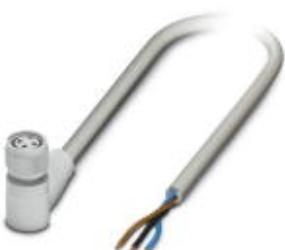
Кабель для датчика / исполнительного элемента, 3-полюсн., PP-EPDM без галогенов, серый RAL 7035, свободный конец, к Гнездо угловой M8, длина кабеля: 3 м, Гигиеничный дизайн, с пластмассовой накатанной гайкой
