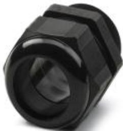
Кабельный ввод, материал резьбового соединения: PA, наружный диаметр кабеля 34 мм ... 44 мм, экранировка: нет, резьба соединительной части: M63 x 1,5, цвет: иссиня-чёрный RAL 9005
