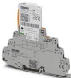
Устройство защиты от перенапряжений (защитный штекер и базовый элемент) со встроенным индикатором состояния и ножевыми размыкателями для трех сигнальных проводников с общим опорным потенциалом. Для высокочастотных приложений и телекоммуникационных интерфейсов без напряжения питания. Непрямое заземление через газовый разрядник.
