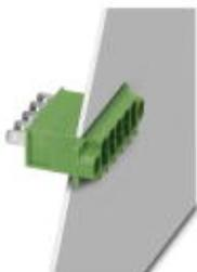
Компоненты для проходного монтажа, номинальный ток: 15 А, расчетное напряжение (III/2): 400 В, полюсов: 5, размер шага: 7,62 мм, тип подключения: Подкл. плоского штекера, цвет: зеленый, поверхность контакта: олово, монтаж: Непосредственный монтаж
