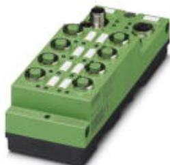
Автономное устройство для INTERBUS имеет 16 цифровых входов. Подсоединение M12 производится с использованием системы быстрого подключения. Цепь питания 24 М DC защищена от короткого замыкания и перегрузки. Номинальный ток устройства составляет 1,2 А.
